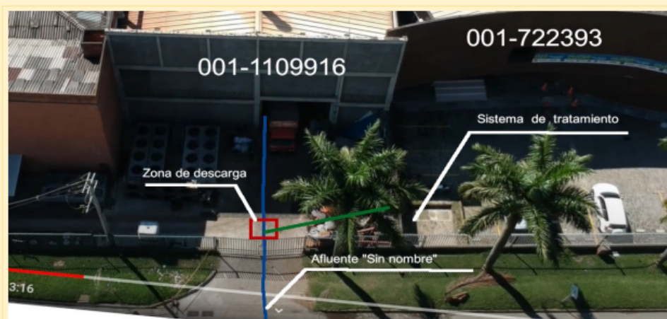
Imagen 11. La alternativa más adecuada es verdaderamente sencilla pues implica trabajos menores en el predio sirviente, generando una brecha (señalada con la línea verde), hasta la conexión con el afluente sin nombre en el recuadro rojo..
